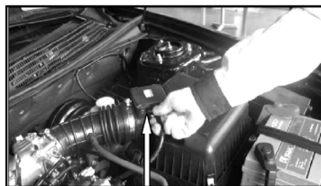
Рис. 4.8.2.1. Расположение датчика расхода воздуха.
