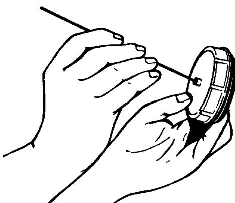
Verifique se o furo do respiro na parte superior da tampa está obstruído. Se necessário, desobstrua com um arame fino.
