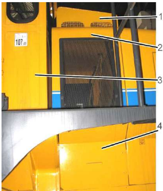
Рис. 10А.5. Снятие переднего, бокового ограждения мотоотсека за кабиной (левая сторона машины)
