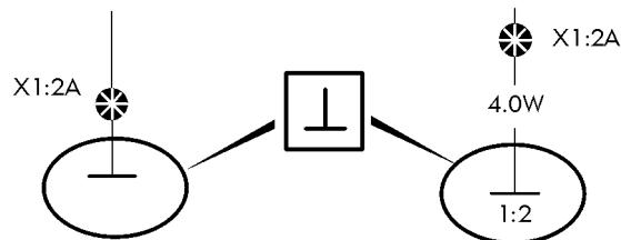
Одна и та же точка подключения может показываться на нескольких схемах. Кабель от точки соединения до заземления отображен и имеет кодировку только на одной схеме (соединения ZC с заземлением). На других схемах он отображается так же, как на иллюстрации.
