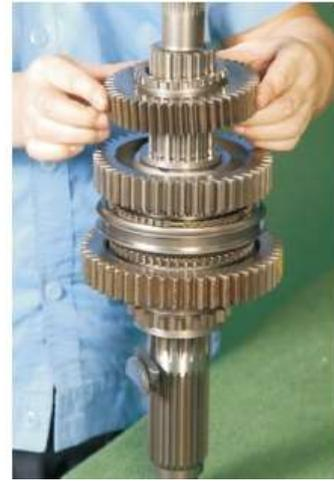
7. Возьмите шестерню второй передачи вторичного вала соединительными зубьями вниз и наденьте на вторичный вал. Обратите внимание на необходимость зацепления с узлом одной стороны синхронизатора, описанного в предыдущем шаге.
