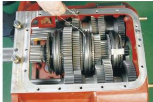
5. Возьмите другой промежуточный вал в сборе, положите его в правую сторону внутреннего пространства корпуса коробки так, чтобы отмеченный зуб на ведущей шестерне совпал с гнездом подшипника первичного вала.
