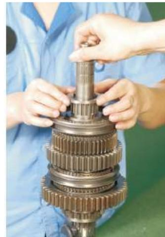
10. Возьмите шлицевую шайбу, наденьте на вторичный вал, продвиньте до кольцевой канавки и проверните на один шаг резьбы, протолкните шестиугольную шпонку через шлицевую шайбу и установите ее на место.
