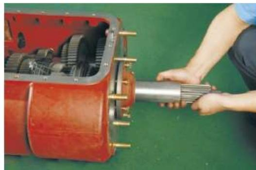
7. Возьмите блок первичного вала, выполните его установку на место вдоль гнезда подшипника первичного вала корпуса главного картера.
