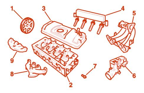
Camshaft pulley (1): 1 da.Nm.
