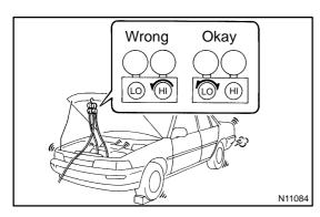
6. DO NOT OPERATE COMPRESSOR WITHOUT ENOUGH REFRIGERANT IN REFRIGERANT SYSTEM
