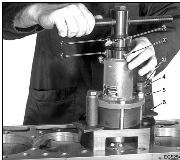
Figura 309 Emplazamiento de la herramienta para abocardar
