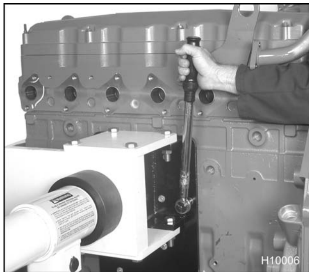
Figura 55 Ajuste de los pernos del motor
