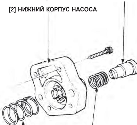
[4] ПРУЖИНА ШТОКА ТОЛКАТЕЛЯ КЛАПАНА
