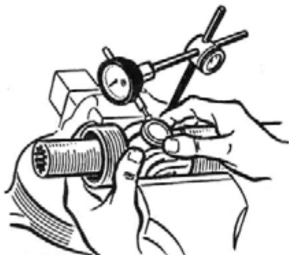
Рис. 208. Измерение радиального зазора в подшипниках карданной передачи
