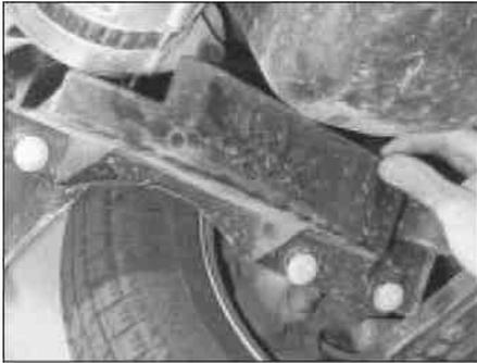
4.3 Удалить вспомогательный приводной ремень ниже покрытие изнутри арки колеса
