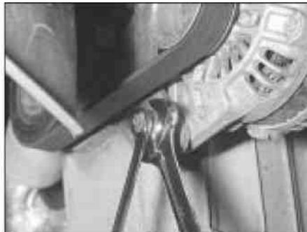
19 Как упомянуто выше, этот тип приводного ремня - tensioned автоматическим механизмом натяжения; регулярные проверки не требуются, и ручное "регулирование" не возможно.
