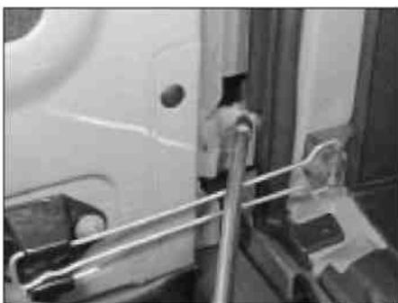
28.2 Отвинчивание зажимного болта крышки шарнира основания на задней двери Курьера
