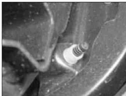
**27.3 Регулировочный плунжер ручного тормоза** расположенный на внутреннем лице каждой задней части щит барабанного тормоза
