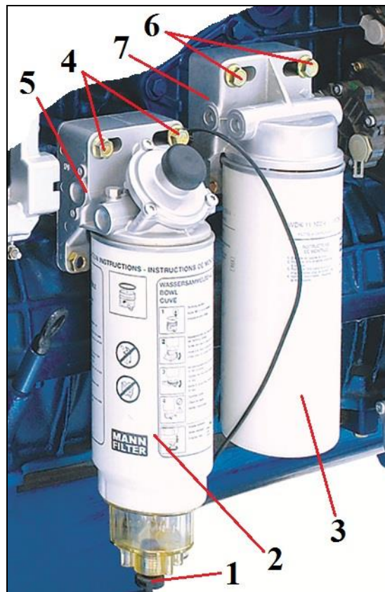
Рис. 22 Снятие топливных фильтров
