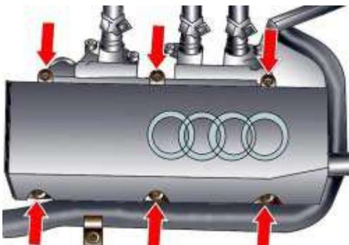
Рис. 3.1–82. Расположение болтов крепления левой крышки головки блока цилиндров
