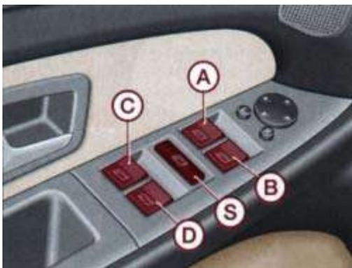
**Рис. 1–9. Расположение переключателей стеклоподъемников в подлокотнике двери водителя: А – дверь водителя; В – дверь переднего пассажира; С – правая задняя дверь; D – левая задняя дверь; S – предохранительный выключатель**
