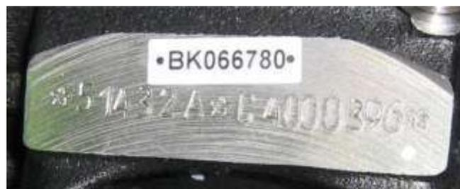
Рисунок Ж.2. Маркировка двигателя ударным способом на блоке цилиндров:
