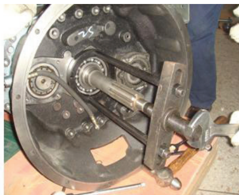
Рис. 8б: Снятие подшипника входного вала при помощи съемника
