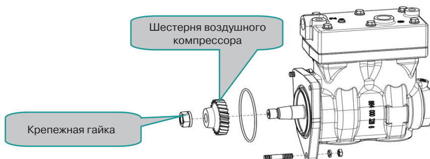
Рис. 7. Установка воздушного компрессора
