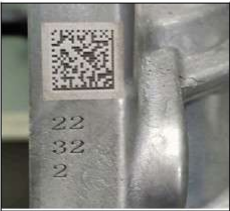
Группировка главной шейки коленчатого вала: 5 цифр, выбитых на четвертой секторной пластине коленчатого вала слева направо, представляют собой группу диаметров 1-й, 2-й, 3-й, 4-й и 5-й главных цапф соответственно. Диаметр основной шейки картера разделен на 3 группы по 1, 2, 3.
