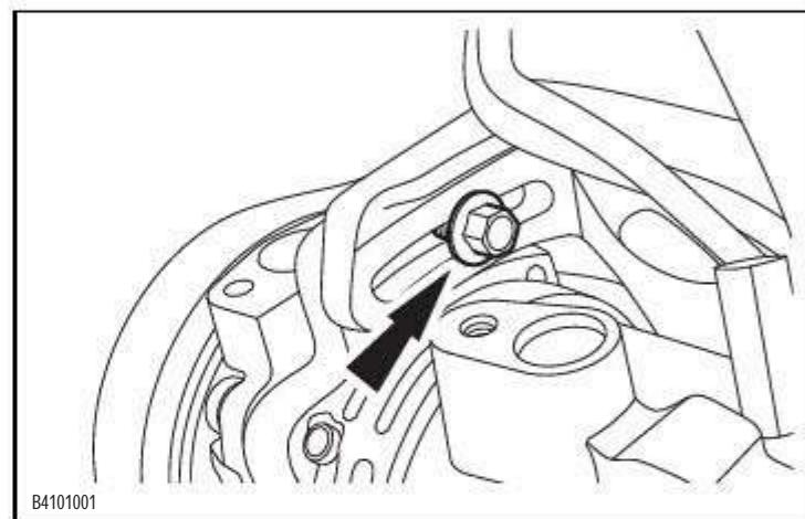
8. Снимите 2 крепежных болта и компрессор.
