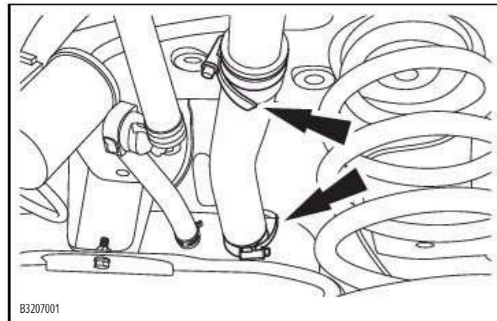
8. Снимите фиксатор узла топливозаправочной трубы
