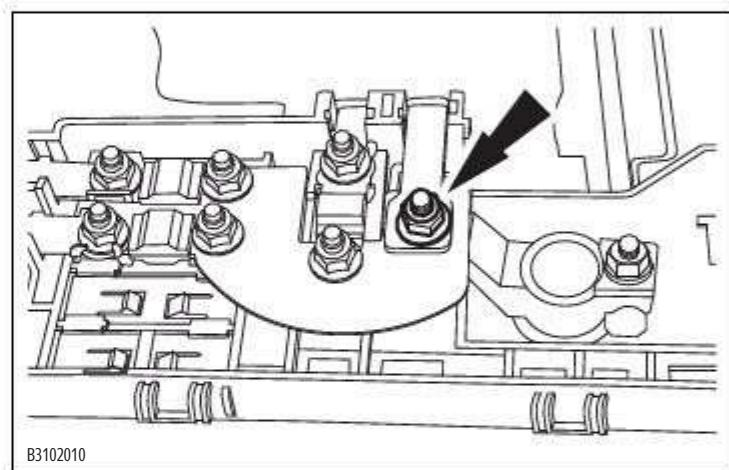
11. Снимите стопорную гайку с жгута проводов зарядки.
