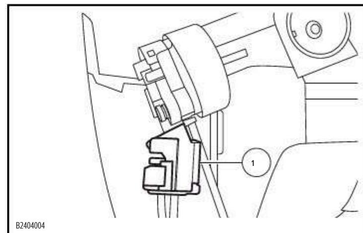
9. Отсоедините проводку рулевой колонки
