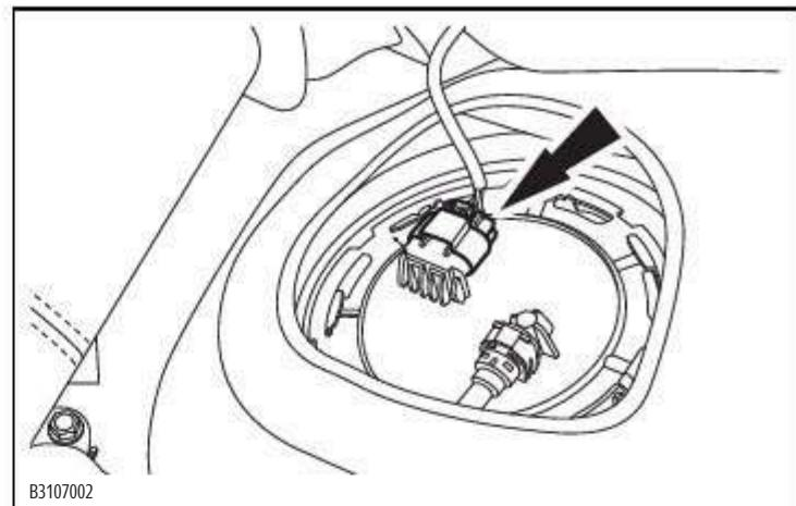
2 Вытяните быстроразъемный соединитель вверх и отсоедините топливопровод влево в направлении, указанном стрелкой.
