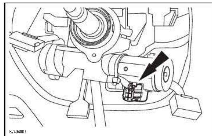
8. Отсоедините проводку рулевой колонки
