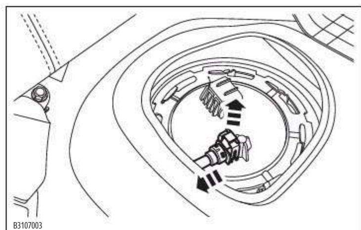
3 С помощью специального инструмента снимите фиксирующее кольцо и топливный насос.
