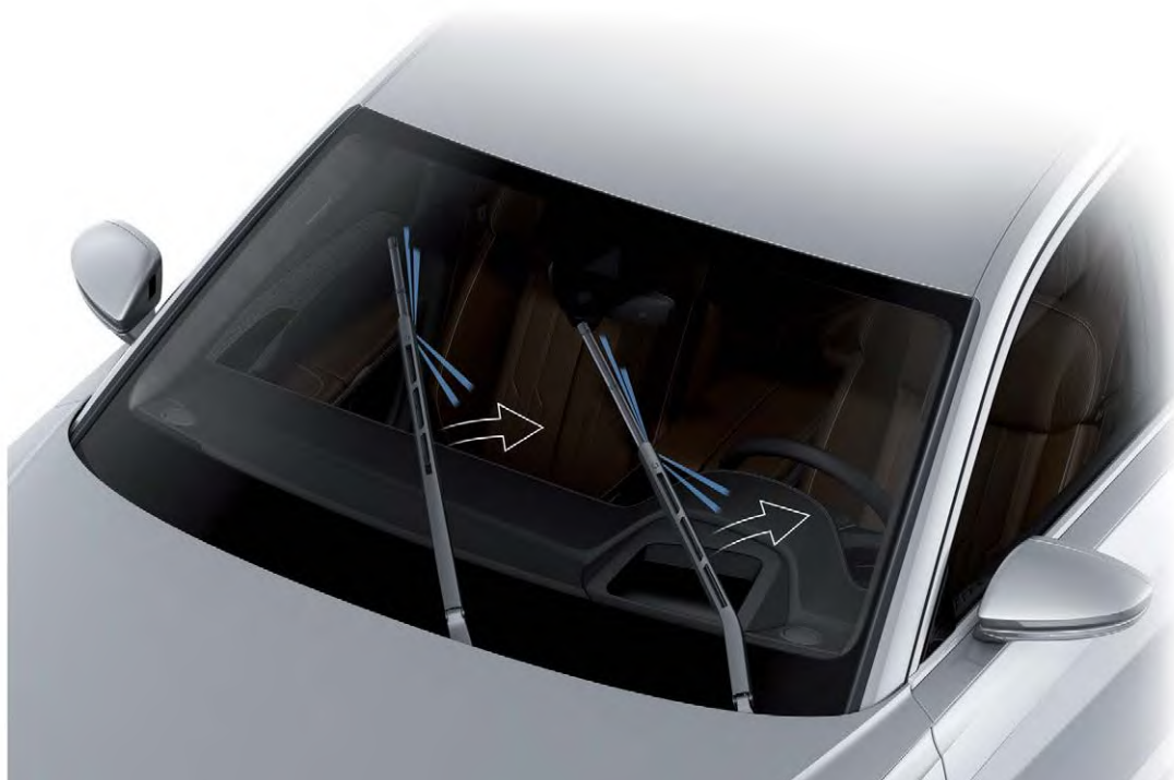
Работают форсунки с нижней стороны щётки
