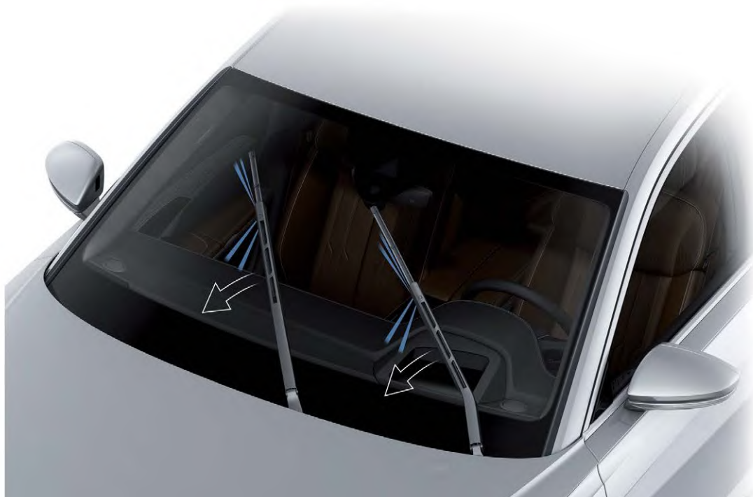
Работают форсунки с нижней стороны щётки
