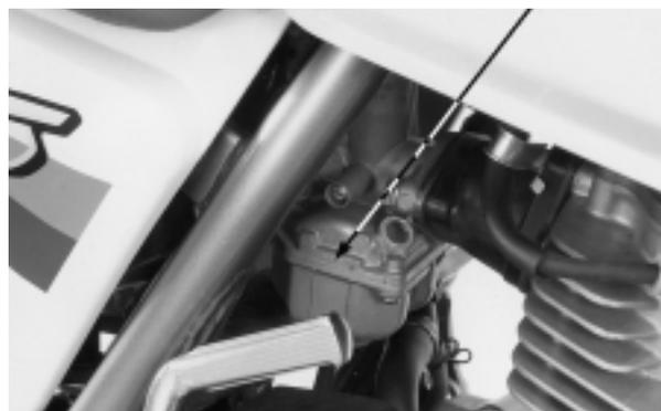
El número de identificación del carburador está grabado en el costado derecho del cuerpo del carburador.
