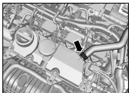
3. Отсоедините электрические разъемы катушек зажигания.
