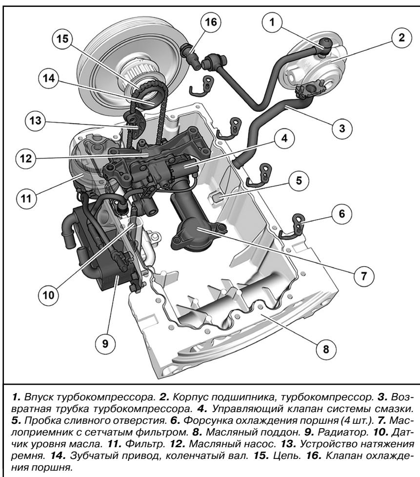
В системе смазки двигателя используется масляный насос (12) переменной производительности и форсунки охлаждения поршней (6).
