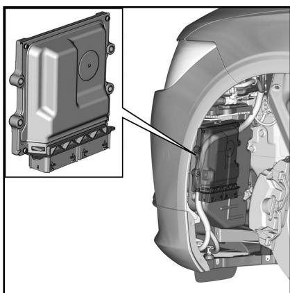
На основании многочисленных входных сигналов ECM управляет двигателем внутреннего сгорания, а также множеством связанных компонентов и других систем в автомобиле. Некоторыми из более центральных областей являются:
