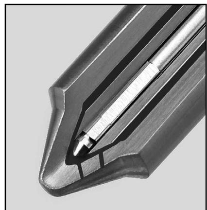
Поскольку игла в распылителе ничем не уплотняется, некоторое количество топлива просачивается между иглой и корпусом форсунки и попадает в полость, где расположена пружина (13). Если топливо не будет удаляться из этой полости, игла распылителя может потерять возможность перемещаться и форсунка окажется «запертой». Для удаления просочившегося топлива служит дренажная система (10).
