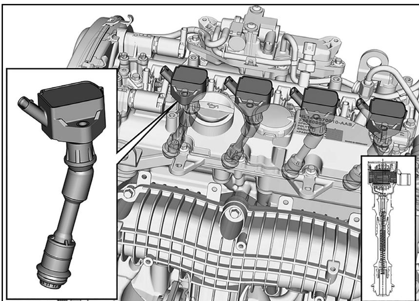
Катушки зажигания имеют более высокую энергоемкость, чем катушки зажигания, предназначенные для распределенного впрыска, которые в определенных последовательностях зажигания могут обеспечивать напряжение зажигания 36 кВ. Разъем имеет три подключения:
