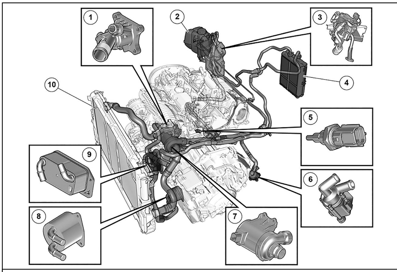
1. Термостат. 2. Расширительный бачок. 3. Топливный отопитель (FOH) (FOH не входит в стандартную комплектацию, а является опцией). 4. Радиатор отопителя. 5. Датчик температуры. 6. Вспомогательный насос охлаждающей жидкости (устанавливается только на автомобилях с FOH). 7. Насос охлаждающей жидкости двигателя, с электроприводом. 8. Масляный радиатор коробки передач. 9. Радиатор моторного масла. 10. Радиатор.
