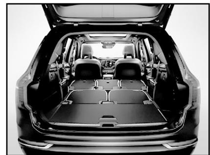
Даже в версиях с тремя рядами кресел багажник Volvo XC90 второго поколения способен вместить до 314 литров груза. Если же сложить сиденья третьего ряда, получается пространство с ровным полом объемом в 692-721 л. В случае, когда несложенными остаются лишь кресла водителя и переднего пассажира, машина вмещает 1951 л груза.
