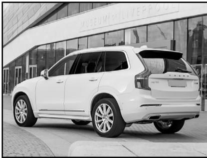
XC90 построен на платформе SPA (Scalable Product Architecture), которая легко адаптируется практически к любым габаритам, типу привода и прочим параметрам. Поэтому новый внедорожник может быть как пяти-, так и семиместным, передне- или полноприводным. Примечательно, что новая модель прибавила в габаритах по сравнению с предшествующей: на 145 мм в длину – до 4950 мм, и на 100 мм в ширину – до 2008 мм. При этом, благодаря новой платформе, новинка стала на 125 кг легче модели первого поколения.
