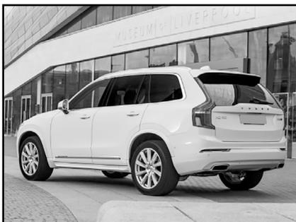
XC90 построен на платформе SPA (Scalable Product Architecture), которая легко адаптируется практически к любым габаритам, типу привода и прочим параметрам. Поэтому новый внедорожник может быть как пяти, так и семиместным, передне- или полноприводным. Примечательно, что новая модель прибавила в габаритах по сравнению с предшественницей: на 145 мм в длину – до 4950 мм, и на 100 мм в ширину – до 2008 мм. При этом, благодаря новой платформе, новинка стала на 125 кг легче модели первого поколения.
