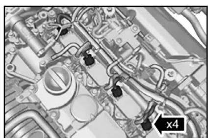
4. Отверните болты крепления и затем снимите катушки зажигания.
