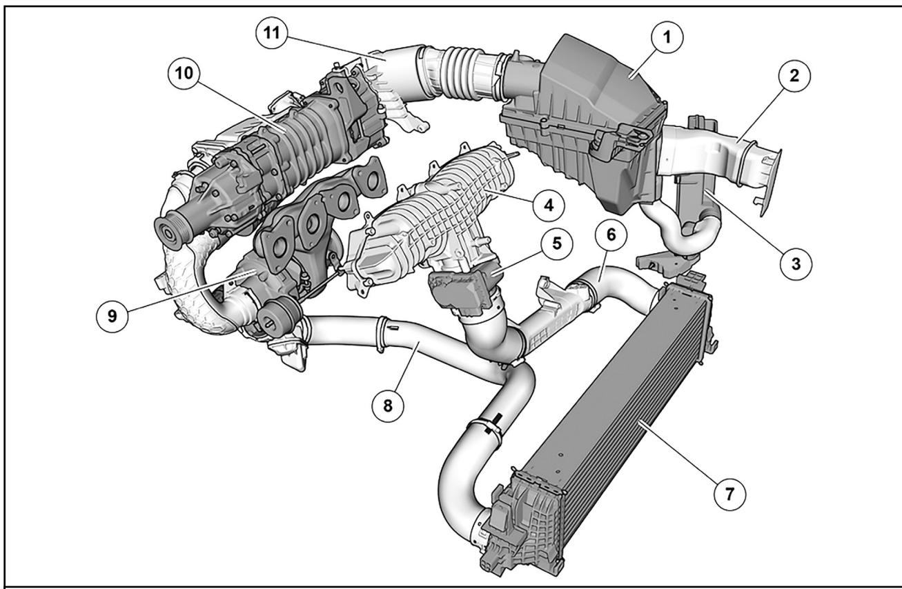
1. Корпус воздушного фильтра. 2. Патрубок забора воздуха. 3. Корпус электронного блока управления двигателем (ECM). 4. Впускной коллектор. 5. Узел дроссельной заслонки. 6. Трубопровод, соединяющий охладитель нагнетаемого воздуха с корпусом дроссельной заслонки. 7. Охладитель нагнетаемого воздуха. 8. Трубопровод, соединяющий турбокомпрессор с охладителем нагнетаемого воздуха. 9. Турбоагрегат. 10. Нагнетатель. 11. Воздуховод от воздухозабора.
