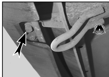
Расположение переднего болта крепления крыла
