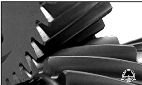
«Закрученные» зубья двух косозубых шестерен входят в зацепление постепенно. Обратите внимание на то, что зубья двух шестерен скручены в противоположных направлениях. Обратите также внимание на то, что сразу несколько зубьев входят в зацепление одновременно – таким образом, увеличивается прочность, так как нагрузка распределяется сразу по нескольким зубьям шестерен.
