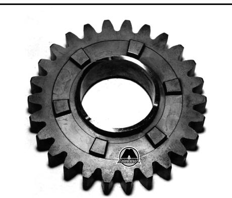
Шестерни данного типа оснащены прямыми, широкими зубьями, которые зацепляются скорее резко, чем плавно. Широкое основание зуба шестерни делает прямозубые шестерни очень прочными, и минимальный контакт между двумя прилегающими зубьями не создает такую силу трения и не поглощает такое количество мощности, как зубья косозубой шестерни. Шум от постоянного контакта зубьев делает данный тип шестерен неподходящим для использования на коробках передач легковых автомобилей.
