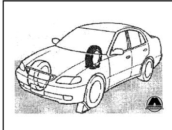
2. Используя баллонный ключ, поворачивайте болты влево, как показано на рисунке, до тех пор, пока они не
