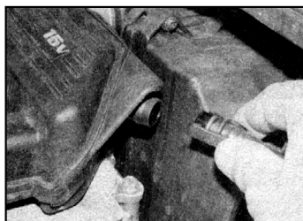
4.2 Сожмите быстроразъемный соединитель и отсоедините шланг вакуумного усилителя тормозов
