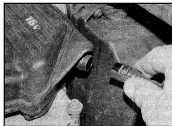
4.16 Отсоедините вакуумный шланг усилителя тормозов от впускного коллектора (1,4-литровый двигатель)
