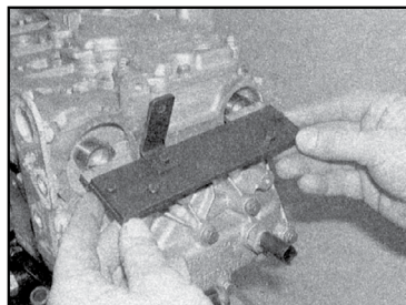
4.13b Введите приспособление фиксации распредвалов в пазы...
