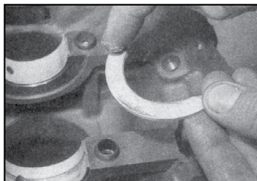
17.6a Нанесите немного смазочного материала на упорные полукольца коленчатого вала...
