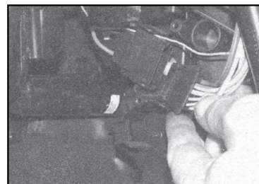
11.33 Отсоедините разъем электропроводки от резистора
