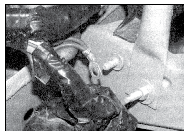
5.13 Отсоедините шину заземления от шасси
