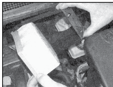
4.3c ...и извлеките фильтрующий элемент
