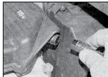
4.2 Сожмите соединитель и отсоедините шланг вакуумного усилителя тормозов
