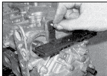
4.13c ... и прикрепите приспособление, вкрутив соответствующий болт в головку блока цилиндров
