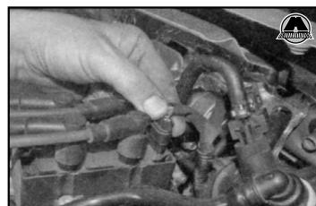
C Проверьте состояние всех электрических разъемов и проводов на всех важных соединениях электрической системы двигателя. Обратите особое внимание на датчик положения коленвала.
