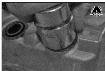
4.20b ... запрессовав их при помощи подходящей насадки.
