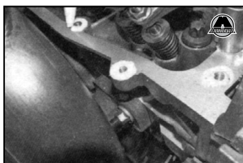
4.19a Нанесение слоя герметика на установочные отверстия под болты со стороны выпускного коллектора.
