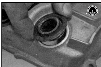
4.20a Установите уплотнения в трубки свечей зажигания на крышке головки блока цилиндров ...
