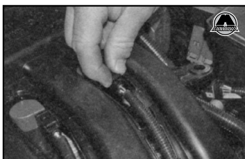
B Проверьте надежность крепления выводов высоковольтных проводов на моделях автомобилей, оснащенных бензиновым двигателем объемом 1,2 л. Убедитесь, что электрические разъемы надежно подсоединены к четырем катушкам зажигания на моделях автомобилей, оснащенных бензиновыми двигателями объемом 1,4 и 1,6 л.
