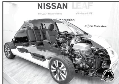
В остальном конструкция Nissan LEAF вполне традиционна: подвеска со стойками McPherson впереди и спаренными продольными рычагами сзади, реечный рулевой механизм с электроусилителем, дисковые тормоза всех колес.
