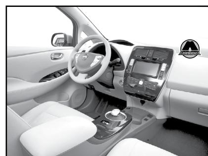
Благодаря достаточно длинной колесной базе (2700 мм) салон Nissan LEAF довольно просторен — в нем достаточно пространства для пяти человек и багажа. Интерьер модели оформлен в стиле hi-tech. В центре передней панели располагаются кнопки управления аудиосистемой и климатической установкой, а также сенсорный дисплей фирменной навигационно-информационной системы EV-IT, которая, помимо всего прочего, в любой момент оповестит водителя о запасе электроэнергии в аккумуляторных батареях.
