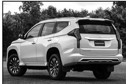
По сравнению с Pajero Sport предыдущего поколения ширина, высота и колесная база остались прежними: 1815 мм, 1800 мм и 2800 мм соответственно. Длина увеличилась на 40 мм — до 4825 мм. Автомобиль обладает внешними параметрами геометрической проходимости: 218 мм дорожного просвета, угол въезда — 30 градусов, съезда — 24 градуса. При этом глубина преодолеваемого борда составляет 700 мм.
