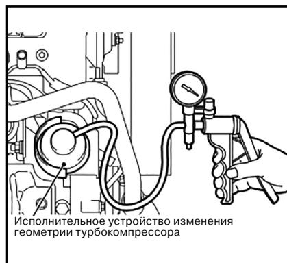
2. Создать разряжение (примерно -57 кПа), чтобы звено штока исполнительного устройства коснулся ограничительного болта.
