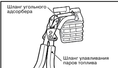
4. Снять защиту наливной горловины топливного бака и перекрыть шланг улавливания паров топлива (со стороны топливного бака) (автомобили с дизельными двигателями).
