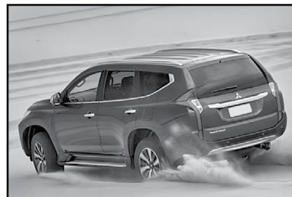
По сравнению с Pajero Sport предыдущего поколения ширина, высота и колесная база остались прежними: 1815 мм, 1800 мм и 2800 мм соответственно. Длина увеличилась на 90 мм — до 4785 мм. Автомобиль обладает внушительными параметрами геометрической проходимости: 218 мм дорожного просвета, угол въезда — 30 градусов, съезда — 24 градуса. При этом глубина преодолеваемого брода составляет 700 мм.
