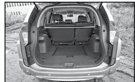
Объем багажного отделения огромен уже при стандартном положении задних сидений — целых 700 л. Специальная сетка позволяет закрепить мелкий багаж, а для перевозки крупногабаритных грузов можно сложить сиденья заднего ряда — так в машину вмещается до 2,5 м<sup>3</sup> груза. Полноразмерное запасное колесо закреплено сзади под днищем автомобиля.
