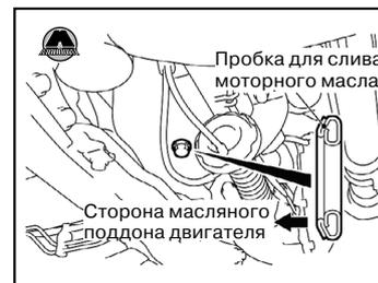
5. Заправить в двигатель установленное количество масла (общее количество масла, включая емкости масляного фильтра и масляного радиатора: 7,4 л). Подобрать требуемую вязкость масла по приведенной ниже схеме.
