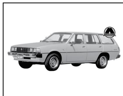
Четвертое поколение Galant появилось в 1980 году в результате глубокого рестайлинга. Автомобиль немного увеличился в размерах и приобрел заднюю независимую подвеску. На эту модель первоначально устанавливался двухлитровый бензиновый двигатель с электронным впрыском, а спустя два года появилась модификация с турбонаддувом. Кроме того, на автомобиль, впервые в Японии, стали устанавливать «легковой» турбодизель объемом 2.3 л.
