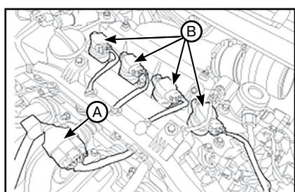
4. Снимите катушки зажигания (A).
