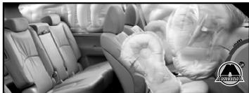
Защиту водителя и пассажиров в случае аварии обеспечивают зоны защищированной деформации кузова, передняя панель с элементами дополнительного усиления, фронтальные и боковые подушки и шторки безопасности. Передние сиденья оборудованы активными подголовниками, защищающими людей от травм шеи («хлыстовой травмы») при ударе автомобиля сзади. Благодаря всем этим мерам Kia Mohave получил наивысший рейтинг безопасности по результатам краш-тестов по методике NHTSA.
