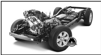
Внедорожный потенциал Mohave обеспечивается не только мощным двигателем и рамной конструкцией. Автомобиль имеет пониженный ряд трансмиссии, регулируемый по высоте клиренс, постоянный полный привод, электронный «Ассистент подъема/спуска» и прочие системы, предназначенные для покорения непроходимой местности.
