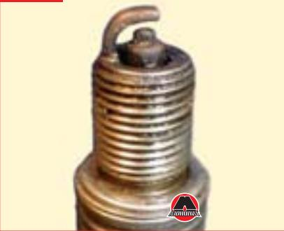
Свеча зажигания, показанная на фото №6, вывернута из неработающего цилиндра. Центральный электрод такой свечи, а также его юбка покрыты плотным слоем масла смешанного с каплями не-
