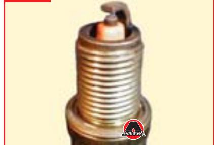
На фото №1 изображена свеча зажигания, вывернутая из нормально работающего двигателя. Юбка центрального электрода имеет светло-коричневый цвет, нагар и отложения минимальны, полное отсутствие следов масла. Такой двигатель обеспечивает оптимальные показатели расхода топлива и моторного масла.
