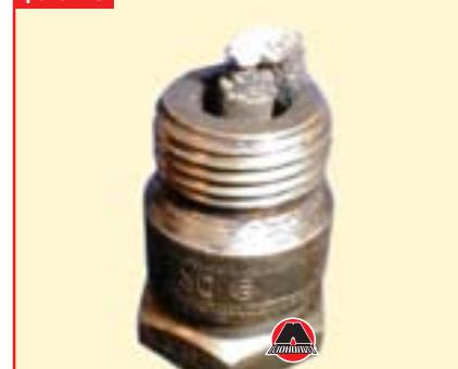
Свеча зажигания, изображенная на фото №8, имеет электрод, покрытый зольными отложениями. При этом цвет отложений не играет решающей роли. Причина такого народа – сгорание масла вследствие износа или залпивания маслосъемных поршневых колец. На двигателе наблюдается повышенный расход масла, из выхлопной трубы валит синий дым. Процедура замены поршневых колец описывается в главе «Механическая часть двигателя».
