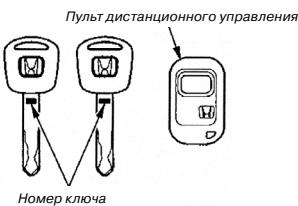
С помощью пульта дистанционного управления представляется возможным отпирать и запирать все двери автомобиля (в т.ч. заднюю откидную дверь) без использования ключей.
