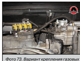
Фото 73. Вариант крепления газовых форсунок и редуктора
