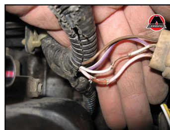
Фото 96. Вариант подключения пульта управления (снимаем изоляцию с розового и белого провода катушки зажигания)
