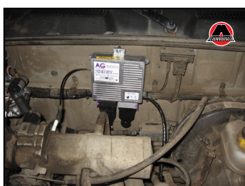
Фото 71. Вариант установки блока управления
