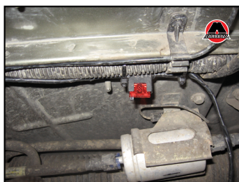
Фото 95. Вариант размещения предохранителя
