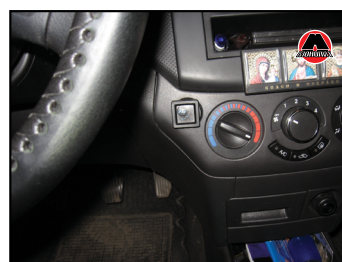
Фото 74. Вариант крепления пульта управления в кабине
