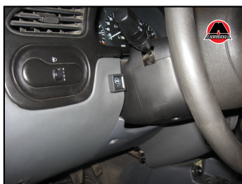
Фото 72. Вариант установки пульта управления в кабине
