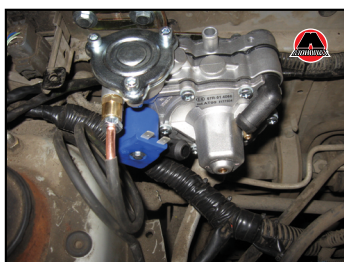
Фото 68. Вариант крепления редуктора
