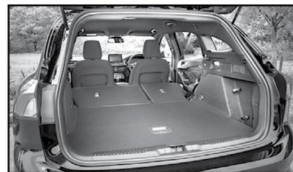
Существенное отличие версии с кузовом типа универсал — багажное отделение. Если объем багажника хэтчбека при обычном положении спинки задних сидений составляет 341 л, то для седана это значение 511 л, а для универсала — 575 л. Если же сложить задний диван (его спинки, кстати, складываются в пропорции 60:40, а также имеют специальный лючок для длинномерных грузов, например лыж), то хэтчбек будет способен вместить 1250 л полезного груза (загрузка до крышки), а универсал — 1620 л.
