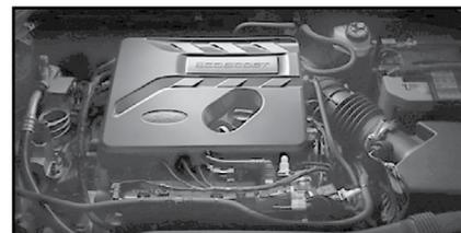
Гамма устанавливаемых на Ford Focus двигателей довольно обширна. Бензиновые EcoBoost — трехцилиндровые 1,0-литровые мощностью 85, 100 и 125 л. с., а также четырехцилиндровые 1,5-литровые мощностью 150 или 185 л. с. Турбодизели EcoBlue — трехцилиндровые 1,5-литровые мощностью 95 и 120 л. с., а также четырех-
