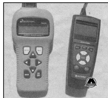
2.2. Диагностические сканеры компаний Actron и AutoXray достаточно мощные и относительно недорогие (по сравнению с профессиональными диагностическими сканерами).
