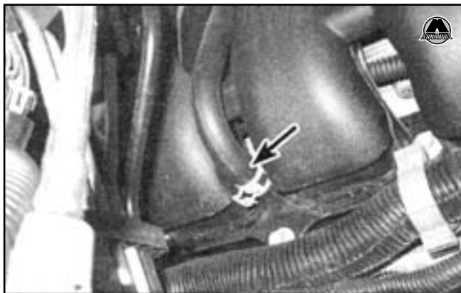
3.6 Отсоедините шланг вентиляции картера от коллектора
