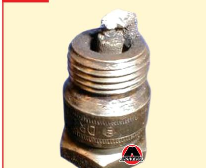
Свеча зажигания, изображенная на фото №8, имеет электрод, покрытый золотыми отложениями. При этом цвет отложений не играет решающей роли. Причина такого нароста – сгорание масла вследствие износа или залипания масляеъемных поршневых колец. На двигателе наблюдается повышенный расход масла, из выхлопной трубы валит синий дым. Процедура замены поршневых колец описывается в главе «Механическая часть двигателя».
