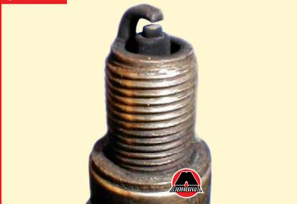
Свеча, изображенная на фото №2, вывернута из двигателя с повышенным расходом топлива. Центральный электрод такой свечи покрыт бархатисто-черным нагаром. Причиной этого могут быть богатая воздушно-топливная смесь (неправильная регулировка карбюратора или неисправность системы электронного впрыска), засорение воздушного фильтра.
