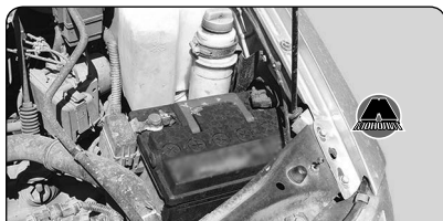
Отсоединение отрицательной клеммы аккумуляторной батареи
