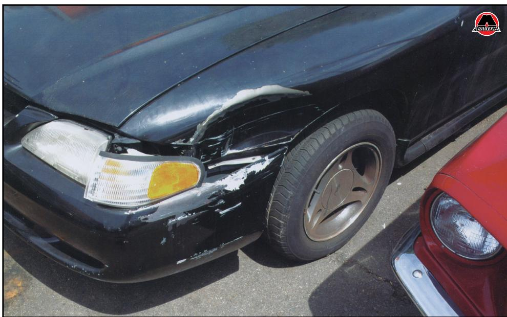
Это крыло автомобиля Mustang кажется не сильно помятым, однако то, как оно деформировалось вокруг фары головного освещения и края бампера и то, что это деталь, которую достаточно легко снять, означает, что будет намного проще заменить ее, чем попытаться выровнять.
