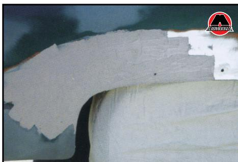
Как и при размешивании наполнителя, необходимо обладать некоторыми навыками и опытом, чтобы определить точное количество наполнителя, которое необходимо нанести на поверхность. Лучше все-таки нанести немнога больше наполнителя, в таком случае вы легко сможете удалить излишки. Однако вы также всегда можете добавить наполнитель, это не столь важно.
