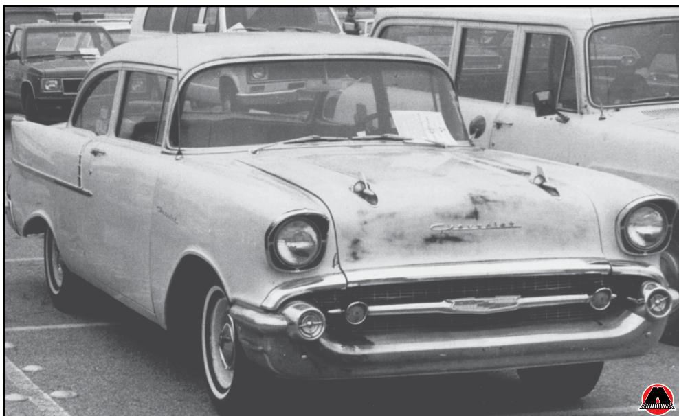
Я увидел этот автомобиль на обменной площадке. Имейте в виду, что некоторые продавцы могут быть хитрыми (кажется, владелец отполировал автомобиль восковой пастой, чтобы улучшить его внешний вид); однако в этом случае не видно следов коррозии, вмятин, трещин или вздутий. Автомобиль отлично подойдет для тщательной шлифовки и покраски. Вы можете приобрести подобный автомобиль за хорошую цену, а потом выполнить покраску самостоятельно.
