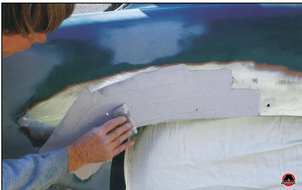
В данном случае, используя пластиковый шпатель средних размеров, я нанес смешанный наполнитель быстро, но гладко и равномерно на вмятину. Одни совет: при нанесении наполнителя не просто растирайте его по поверхности, а слегка вдавливайте его, чтобы убедиться, что он схватился.
