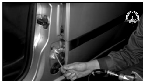
Рис. 27. Обработка дверных стоек.
