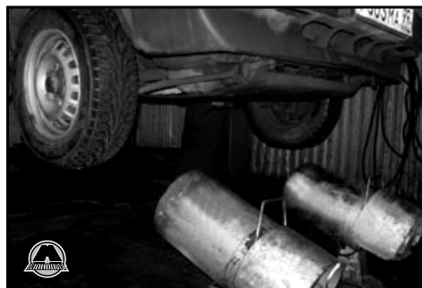
Рис. 16. Обдув сжатым воздухом и сушка.
