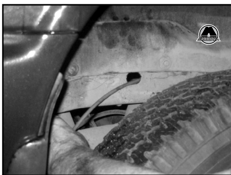
Рис. 25 Обработка через технологические отверстия
