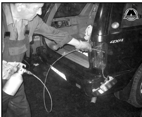
Рис. 26. Обработка полостей задних крыльев через отверстия для крепления задних блок-фар.
