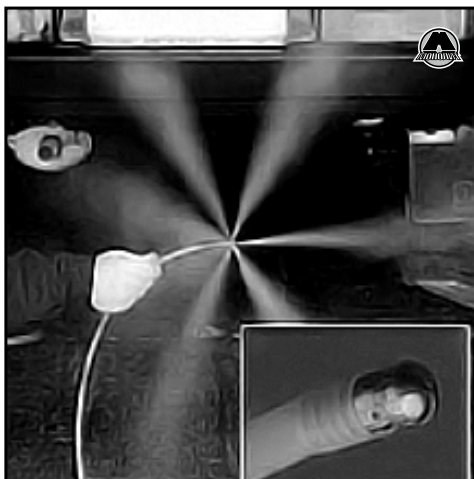
Рис. 40. Насадка для обработки скрытых полостей распыляет препарат во все стороны.
