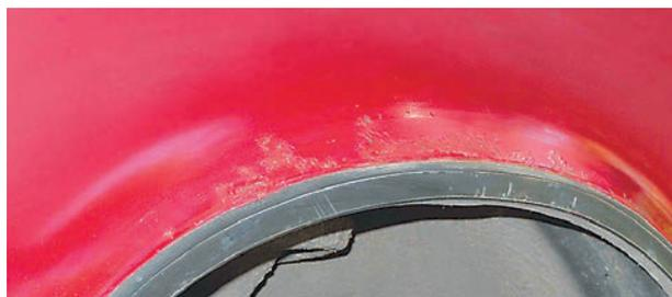
В процессе эксплуатации автомобиля покрытие на днище кузова подвергается воздействию гравия, песка и соли. В результате этого воздействия покрытие днища стирается и оголенный металл начинает ржаветь. Поэтому регулярно следите за состоянием покрытия днища и своевременно восстанавливайте поврежденные участки.
