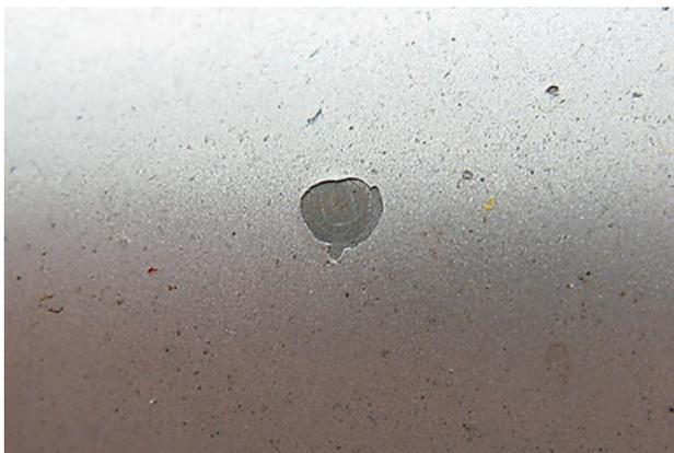
...сколы на днище связаны, как правило, с механическим воздействием посторонних предметов при нормальной эксплуатации автомобиля.
