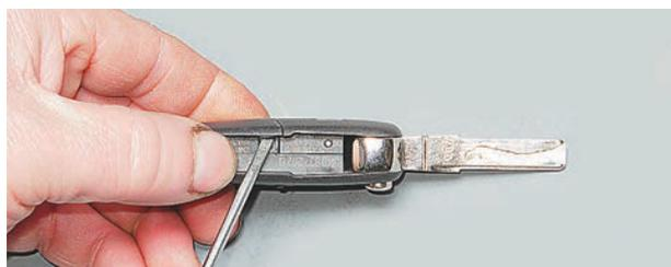
3. Снимаем крышку.
