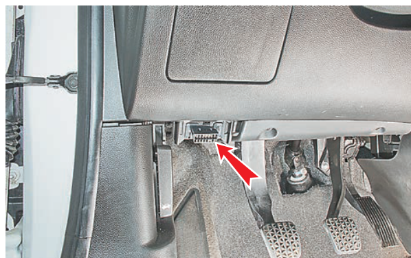
Диагностический разъем стандарта OBD II.
