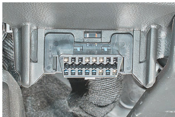
Диагностический разъем стандарта OBD II.
