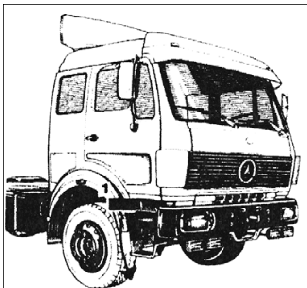
1. идентификационный номер автомобиля указан на правой продольной балке рамы
