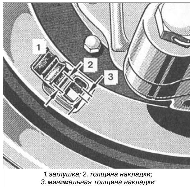
Дисковый указатель на регуляторе рычажного привода: 1. тормозная накладка новая; 2. тормозная накладка изношена
