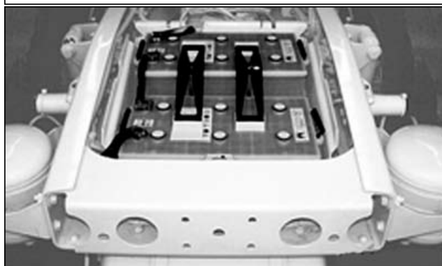
Блок аккумуляторных батарей между лонжеронами
