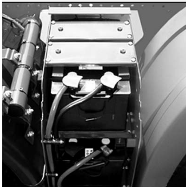
Блок аккумуляторных батарей за кабиной
