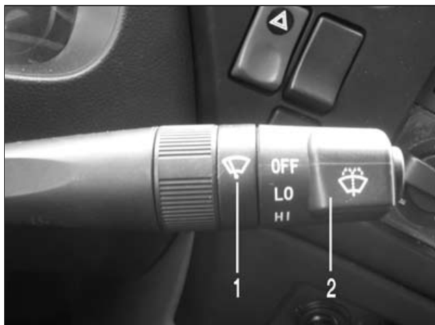
1. знак «щетки стеклоочистителя»; 2. кольцевой переключатель
