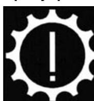
Символ неисправности трансмиссии на главном дисплее свидетельствует о неисправности коробки передач (переключения передач) или о слишком высокой температуре масла в коробке передач.
